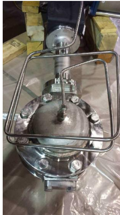
8 CL300 Lug CF8M Cryo Test Flange Setup
