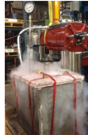
8 CL300 Lug CF8M Cryogenic Test
